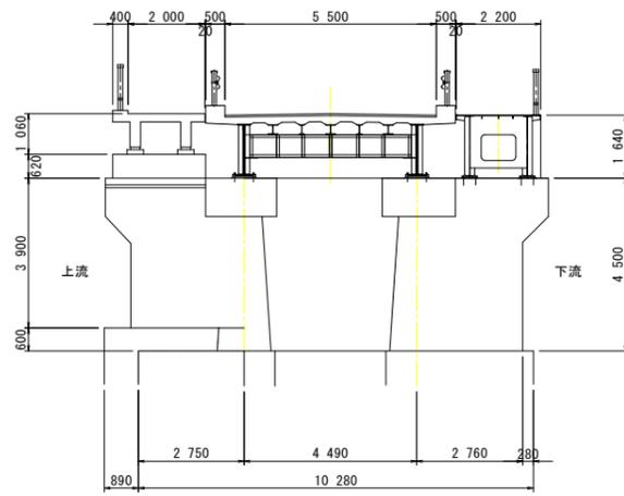
橋脚支点上断面図 S=1:100
