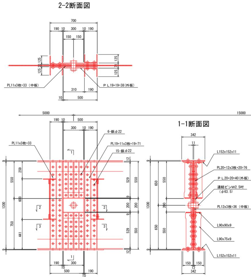
吊桁可動部詳細図
